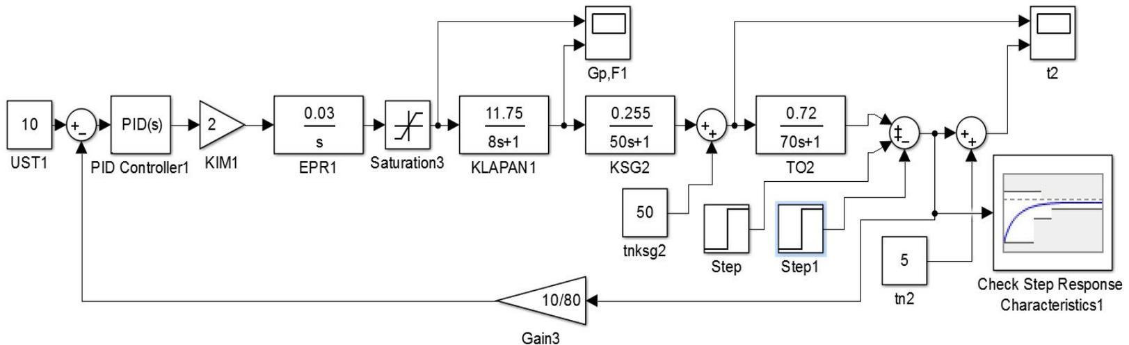
Расчетная модель синтезированной системы автоматического регулирования температуры водонефтяной эмульсии на выходе блочной автоматизированной нагревательной печи ПБА – 2 с имитацией подачи возмущающего воздействия и установленным ограничителем
