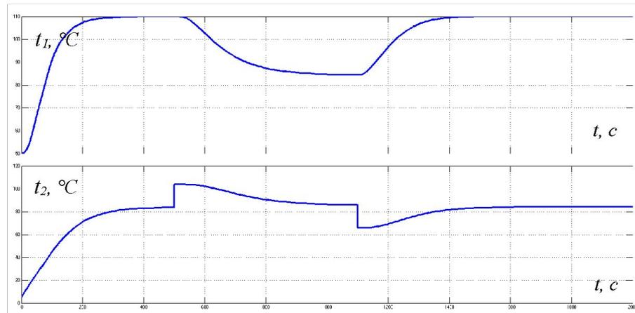
Графики ПП регулирования температуры водонефтяной эмульсии на выходе аппаратов модуля теплогенерации и теплообмена соответственно, синтезированной системы регулирования температуры водонефтяной эмульсии на выходе печи ПБА – 2
