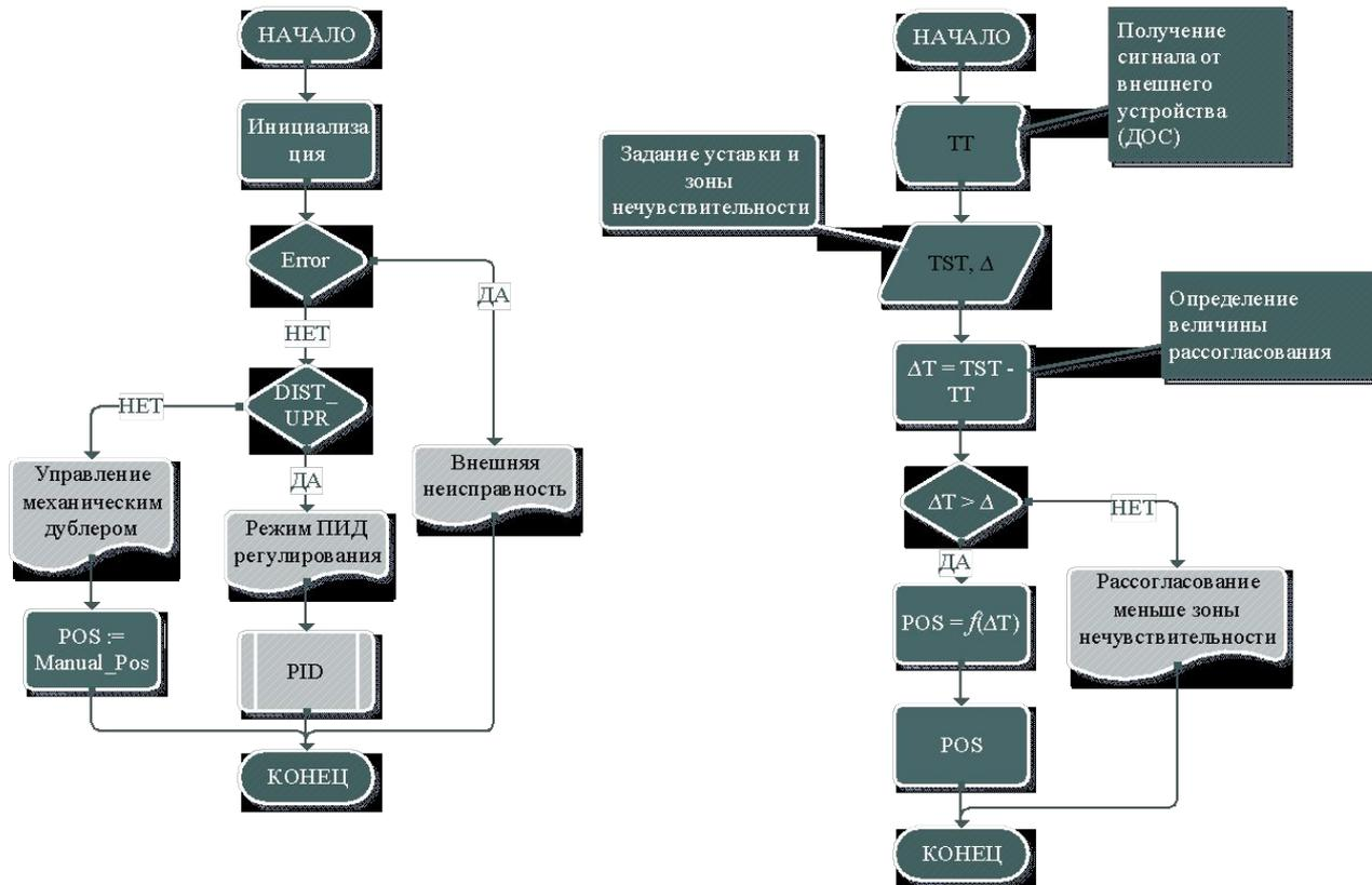
Алгоритмы работы программ регулирования температуры водонефтяной эмульсии на выходе ТО НБАП ПБА – 2 и ЭИМ МЭПК-6300/50-30-Е1-Х6-03(К) модернизируемой АСРТППТ нагревательной печи ПБА – 2
