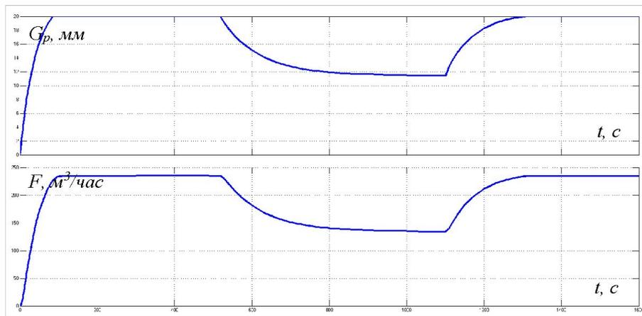
Графики ПП перемещения штока клапана 25с947нж и изменения расхода топливного газа, подаваемого на основную горелку ГГВ – 200 аппарата КСГ – 2 синтезированной системы регулирования температуры водонефтяной эмульсии на выходе нагревательной печи ПБА – 2
