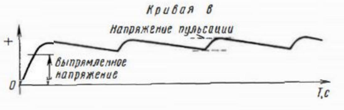
Время полного разряда конденсатора через параллельно подключенный резистор определяется постоянной времени, обычно в тысячи раз превышает время одного полупериода переменного напряжения. Отсюда ясно, что за это время конденсатор не успевает существенно разрядиться, и напряжение на нем понижается от максимального значения на весьма незначительную величину.
