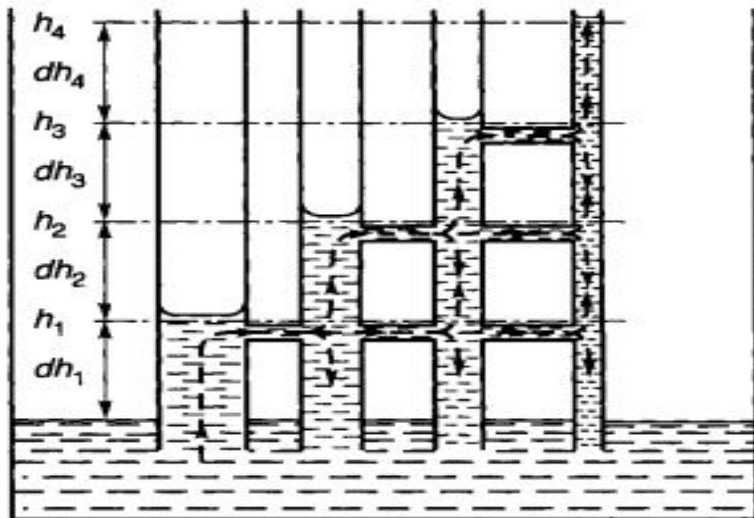
Рис. 11.24. Схема подъема воды в системе взаимосвязанных капилляров (по И.И.Судницину, 1979)
