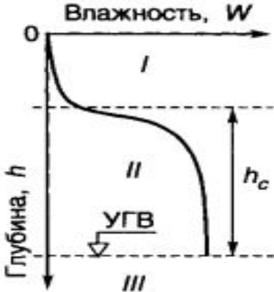
Формирование капиллярной каймы в зоне аэрации: I – зона прочносвязанной воды, II – зона капиллярной каймы, III – грунтовые воды, УГВ – уровень грунтовых вод (Грунтоведение, 2005)
