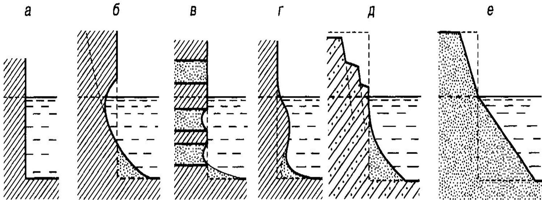
Рис.11.48. Характер размокания различных грунтов в стенках выработок
