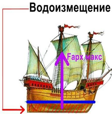
При погружении до ватерлинии на судно действует максимальная сила Архимеда
