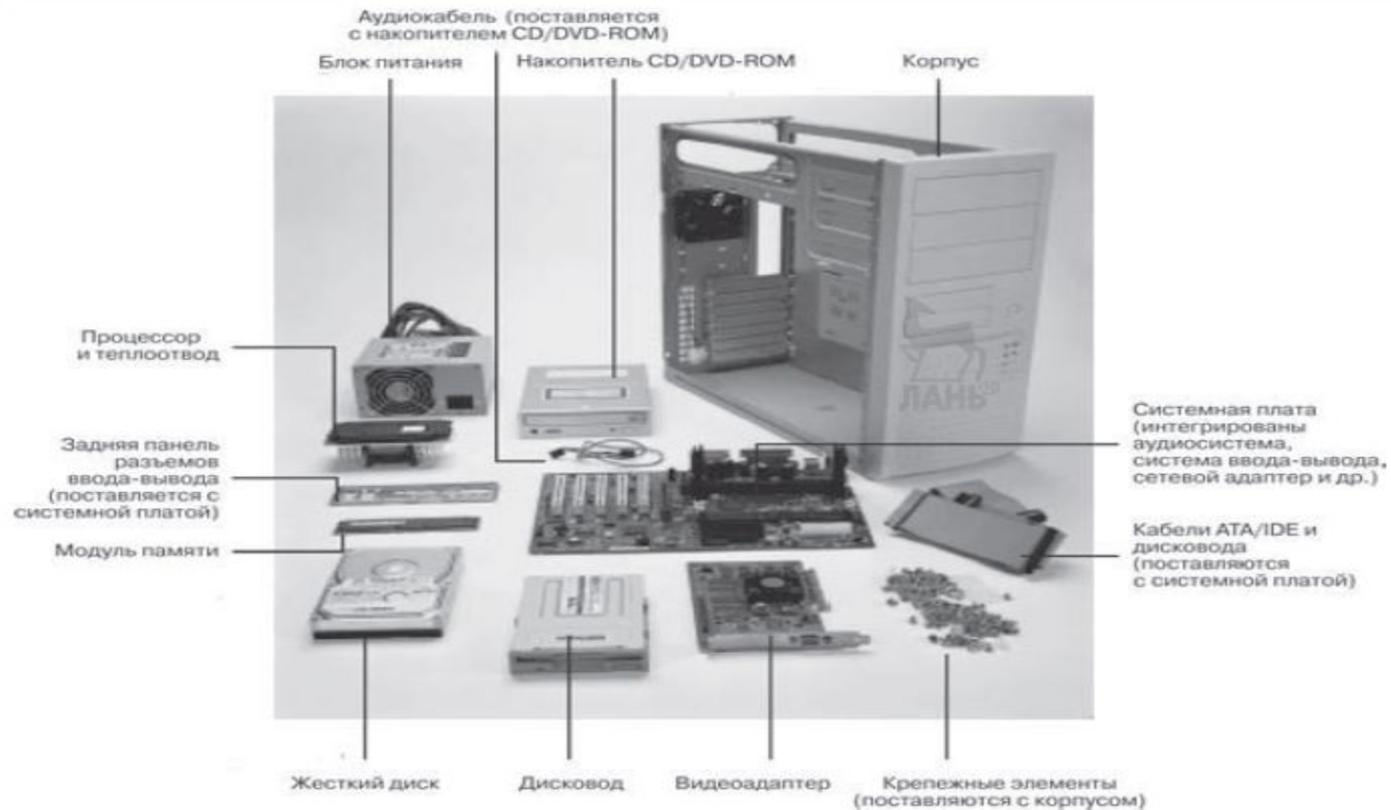
Рис. 5.9. Состав системного блока ПК
