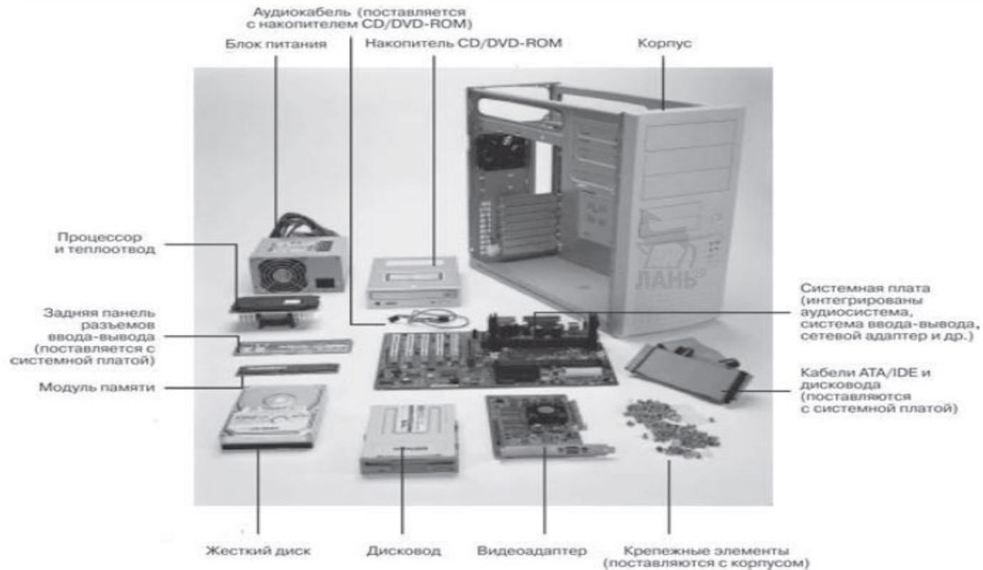
Рис. 5.9. Состав системного блока ПК
