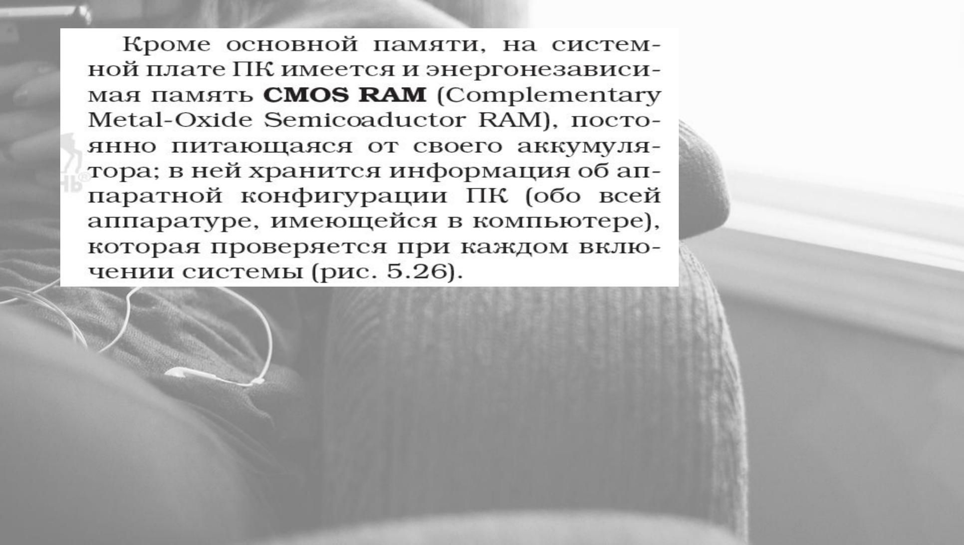
Кроме основной памяти, на системной плате ПК имеется и энергонезависимая память **CMOS RAM** (Complementary Metal-Oxide Semiconductor RAM), постоянно питающаяся от своего аккумулятора; в ней хранится информация об аппаратной конфигурации ПК (обо всей аппаратуре, имеющейся в компьютере), которая проверяется при каждом включении системы (рис. 5.26).
