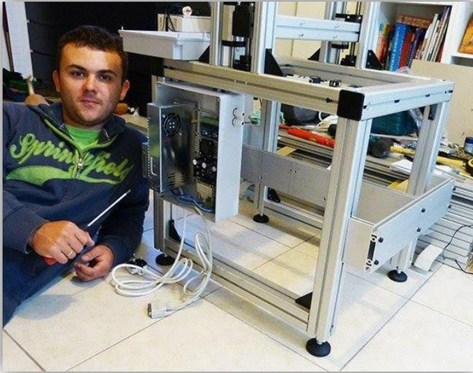
Технология работает так: лазерный луч направляется на фото-полимер, после чего материал затвердевает.
