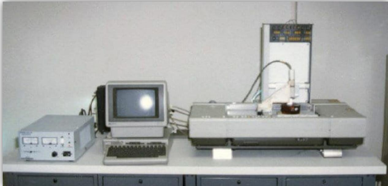
Технология «трёхмерной печати» появилась в конце 80-х гг. XX в. Пионером в этой области является компания 3D Systems, которая разработала первую коммерческую стереолитографическую машину – SLA – Stereolithography Apparatus (1986 г.). До
