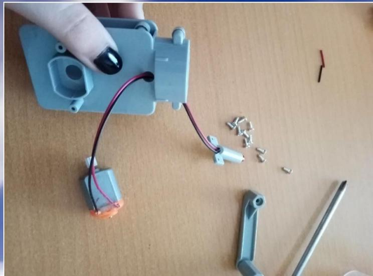
Установить две половинки корпуса электрогенератора и присоединить мотор
