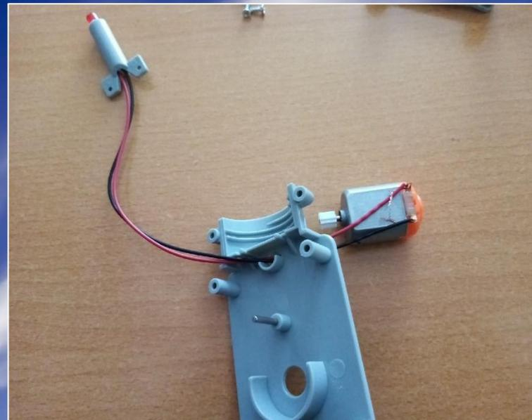
Продеть провода через крышку коробки и подключить их от лампочки к электрогенератору
