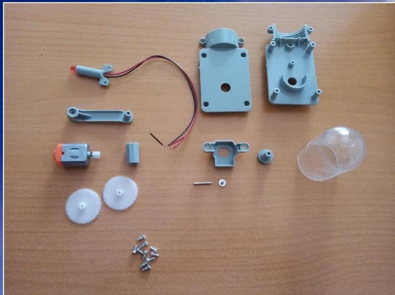
Подготовить детали для сборки макета электрогенератора.
