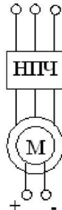
Блок-схема системы НПЧ-СД
