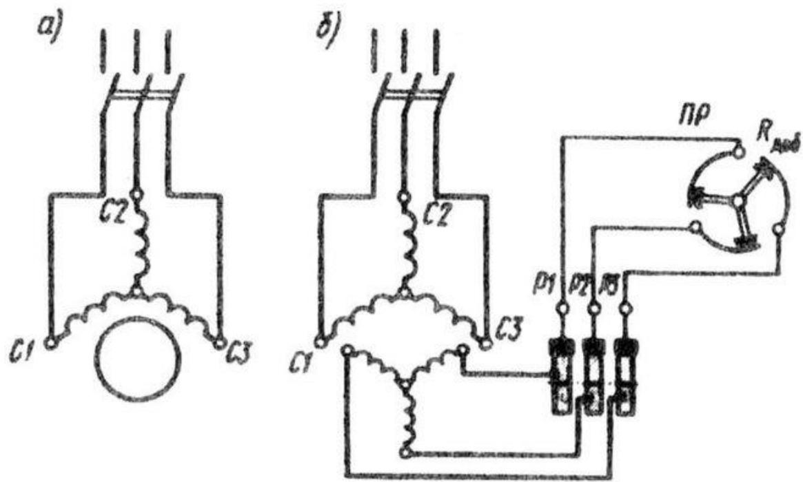
Принципиальные схемы включения трехфазных асинхронных двигателей с короткозамкнутым (а) и фазным (б) ротором
