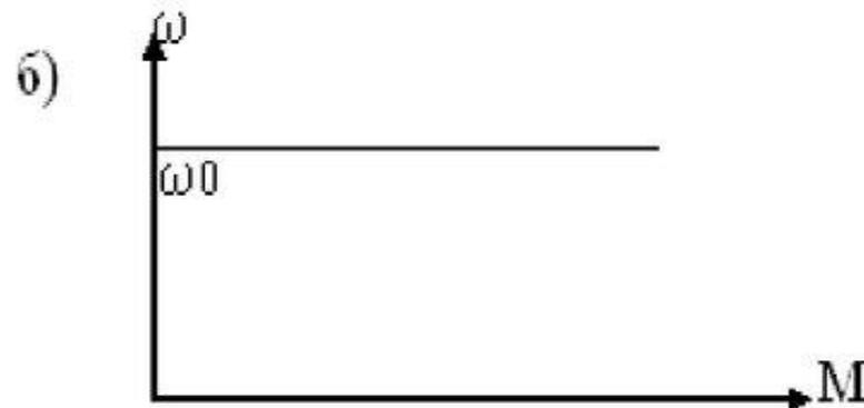
Механические характеристики синхронного двигателя
