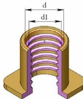
**Шаг резьбы  $P$**  – расстояние между соседними одноименными боковыми сторонами профиля, измеренное вдоль оси резьбы.
