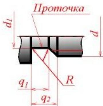
Участок конечных витков резьбы, имеющих неполный профиль, называется сбегом резьбы. Сбег резьбы образуется при отводе режущего инструмента или от его заборной части.
