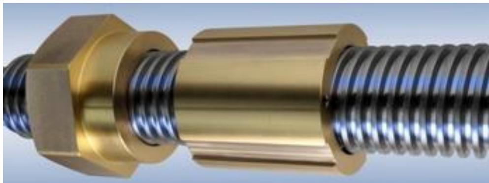
*Трапецеидальная резьба винта* – это ходовая резьба, обладающая относительно большой силой трения, она является самотормозящей. Преимущество для подъемных технологий - в положении покоя не требует дополнительного фиксирования.
