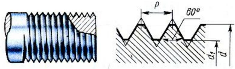
**Диаметр резьбы**– диаметр воображаемого цилиндра, описанного вокруг вершин наружной или впадин внутренней резьбы ( **$D$** ,  **$d$** ).
