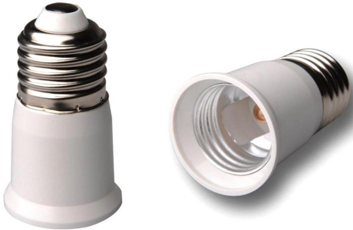
*Круглая резьба ГОСТ 2746-90Е предназначена для цоколей и патронов электрических ламп. Профиль круглой резьбы, изготавливаемой накаткой на тонкостенных изделиях, характерен малой высотой и отсутствием прямолинейного участка, что важно для уменьшения деформации металла в процессе накатки*
