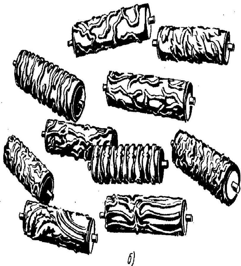
Рис. 122. Отделка поверхностей стилизованными узорами (а) и набор валиков для отделки (б)
