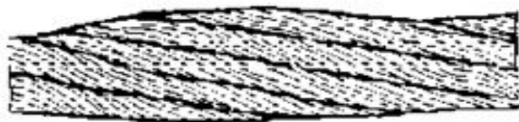
д) местное увеличение диаметра каната
