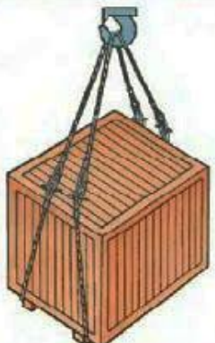
СТРОПОВКА ДВУМЯ ДВУХПЕТЛЕВЫМИ СТРОПАМИ ОБОРУДОВАНИЯ В ДЕРЕВЯННОЙ ТАРЕ
