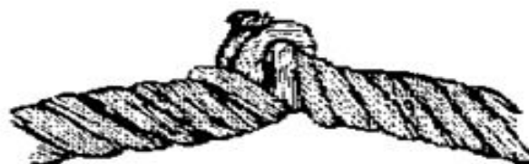
ж) перекручивание каната
