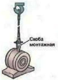
СТРОПОВКА ЭЛЕКТРОДВИГАТЕЛЯ ДВУХПЕТЛЕВЫМ СТРОПОМ
