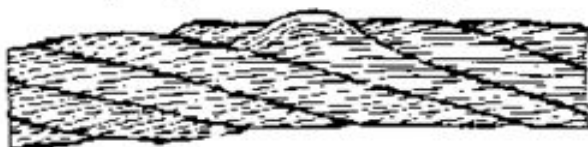
в) выдавливание проволок в одной пряди
