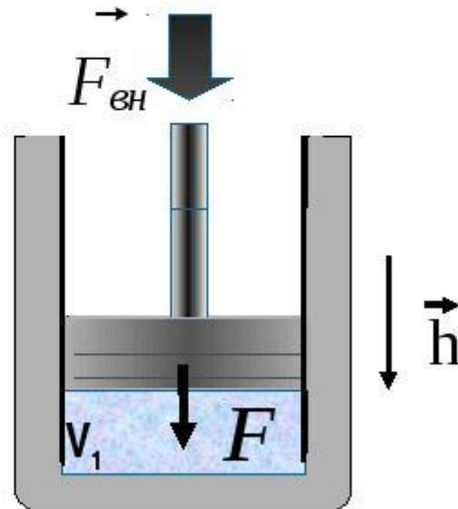
Работа, совершаемая газом в процессе его расширения (или сжатия) при любом термодинамическом процессе, численно равна площади под кривой, изображающей изменение состояния газа на диаграмме  $p$ ,  $V$ .
