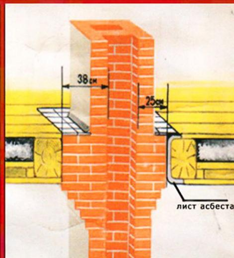
В местах соприкосновения печи или дымовой трубы со сгораемыми конструкциями дома должны быть устроены кирпичные разделки толщиной не менее 38 см; при условии защиты деревянных конструкций асбеста или войлоком, смоченным в глиняном растворе. - 25 см.
