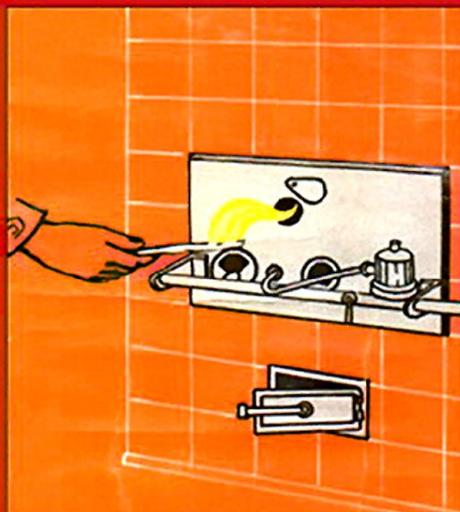
Перед растопкой печей, оборудованных под газовое отопление, проветрите топливник, затем убедитесь, есть ли тяга в дымоходе.
