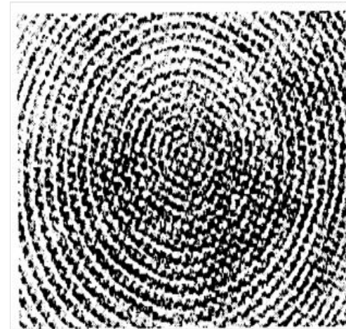
Рис. 77. Спиральная ступенька роста на кристалле SiC
