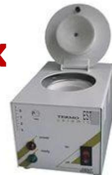
В стерилизаторах, стерилизующим средством в которых является среда нагретых стеклянных шариков (гласперленовые шариковые стерилизаторы), стерилизуют изделия, применяемые в стоматологии (боры зубные, головки алмазные, дрельборы, а также рабочие части гладилок, экскаваторов, зондов и др.). При стерилизации стеклянные шарики нагреваются до температуры 190-240 °С. Стерилизация проводится в течение 5 - 15 секунд.
