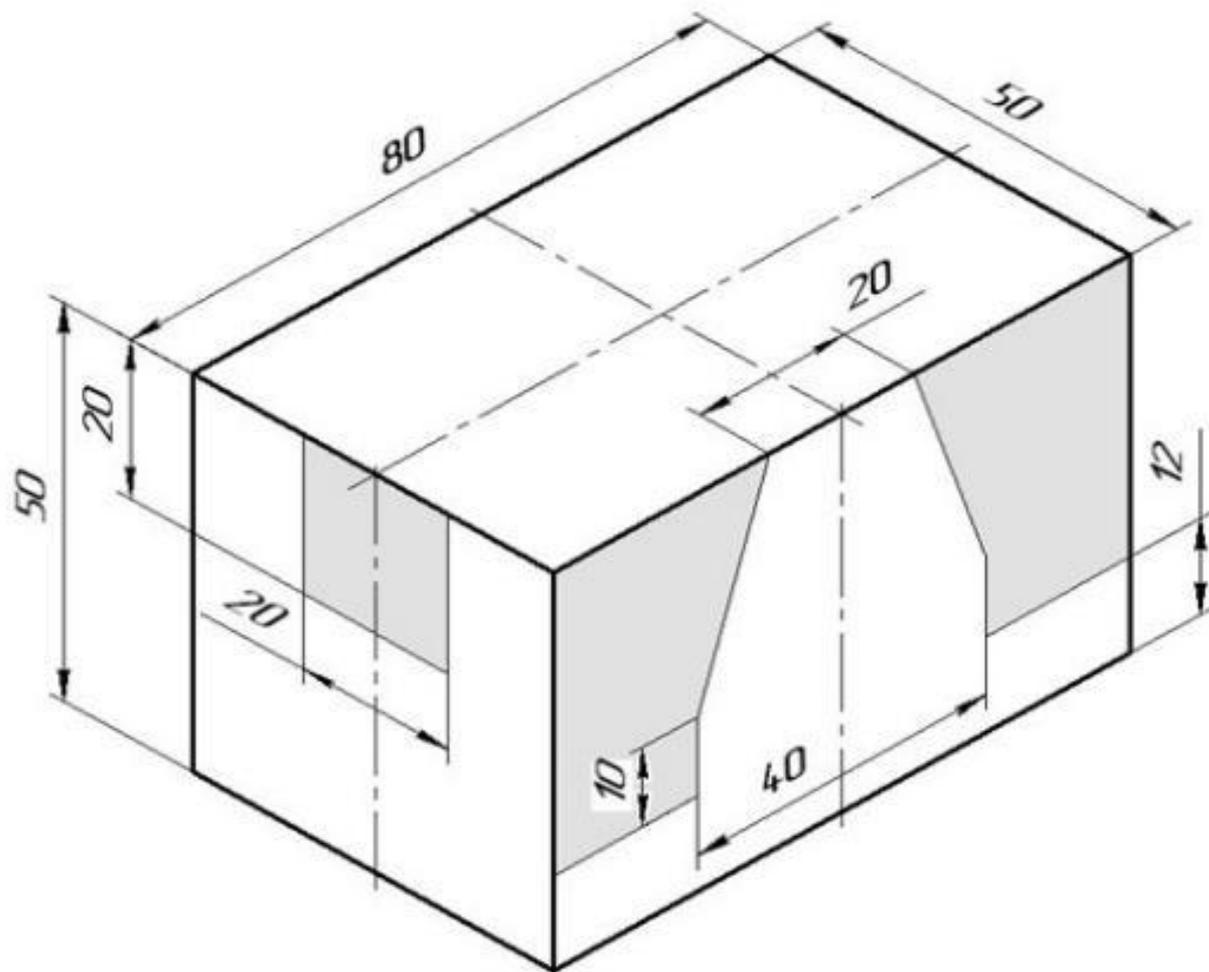
**Задание:** Выполните чертёж детали, у которой вырезаны части по нанесенной разметке. Нанесите размеры. Выполните наглядное изображение полученной детали и нанесите размеры.
