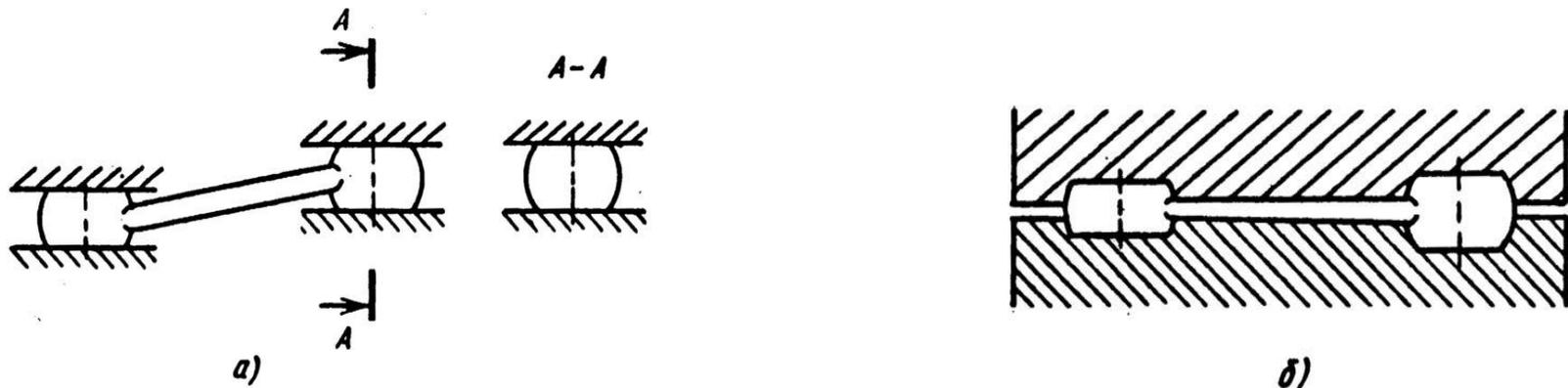
**Рисунок 11.3** – Схема калибровки (а – плоскостная; б – объемная)
