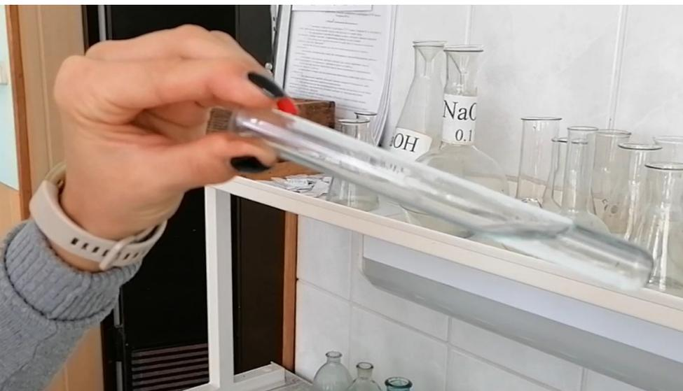
Влить кислоту в пробирку, стараясь не смочить ее стенок. Держа пробирку наклонно (как это изображено на рис. 3), поместить всю навеску металла на верхнюю сухую стенку пробирки так, чтобы металл раньше времени не упал в кислоту.
