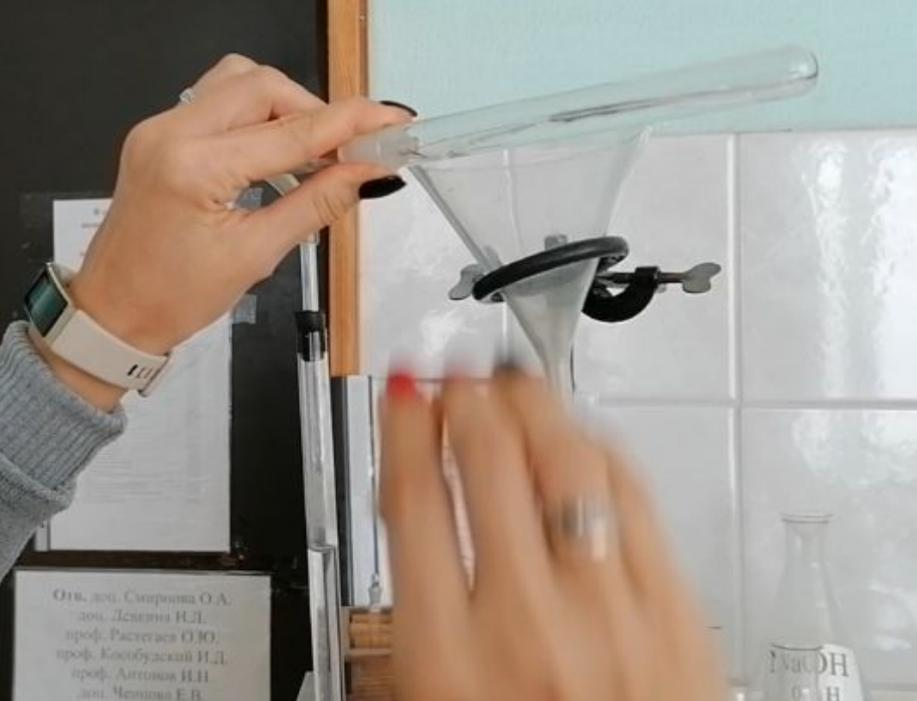
Плотно закрыть пробирку пробкой, следя за тем, чтобы металл раньше времени не упал кислоту (рис. 4 а). Отметить и записать начальный уровень воды в бюретке ( $a_1$ ) и стряхнуть металл в кислоту.
