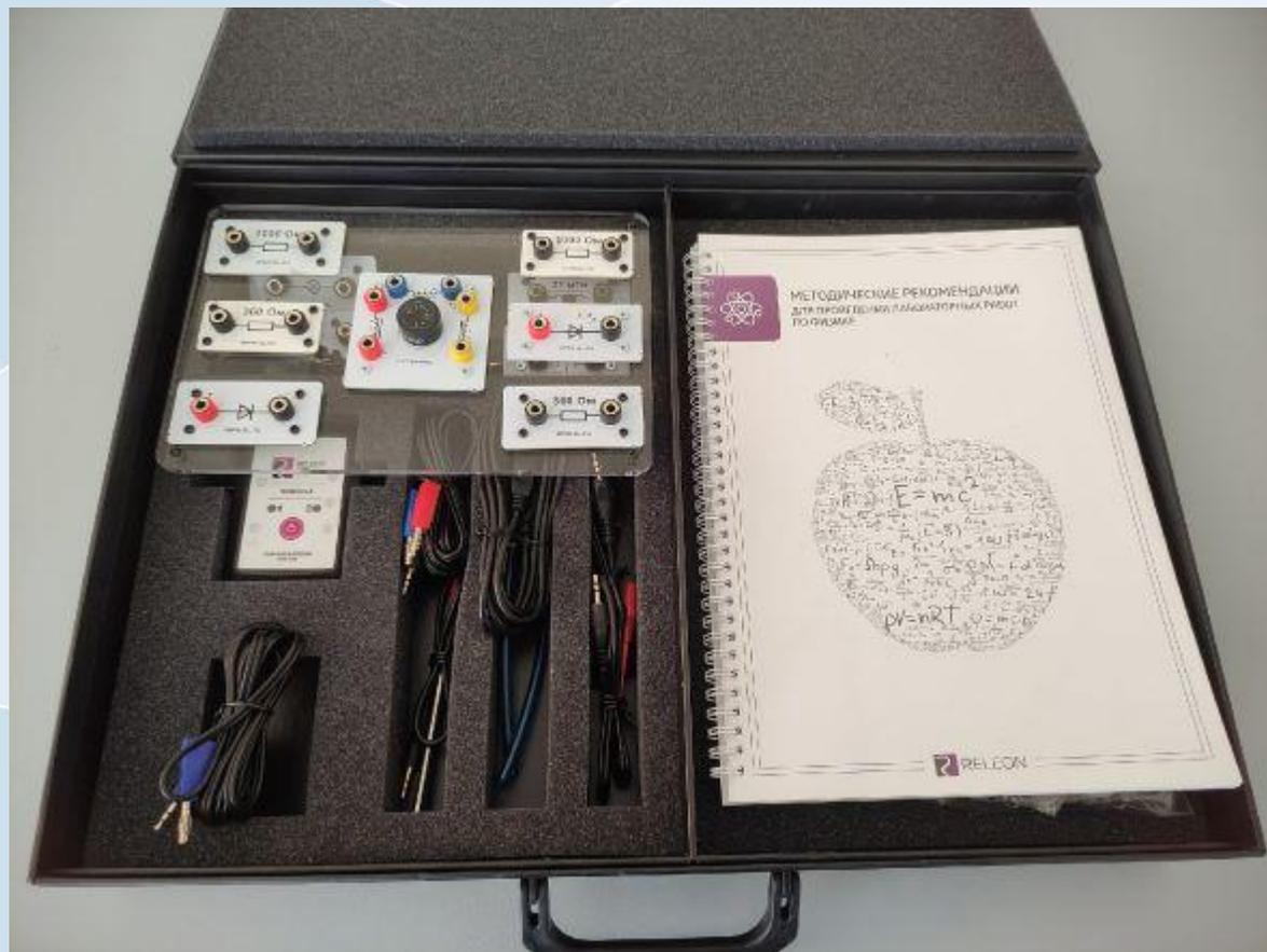
В состав профильной цифровой лаборатории входит один беспроводной мультидатчик Releon Air «Физика-5», программное обеспечение Releon Lite и двухканальная приставка-осциллограф.
