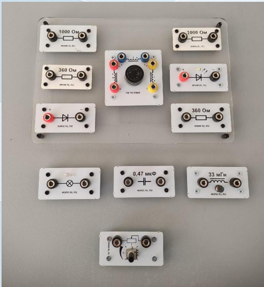
Для изучения законов постоянного и переменного тока в комплект включены дополнительно элементы электрических цепей:
