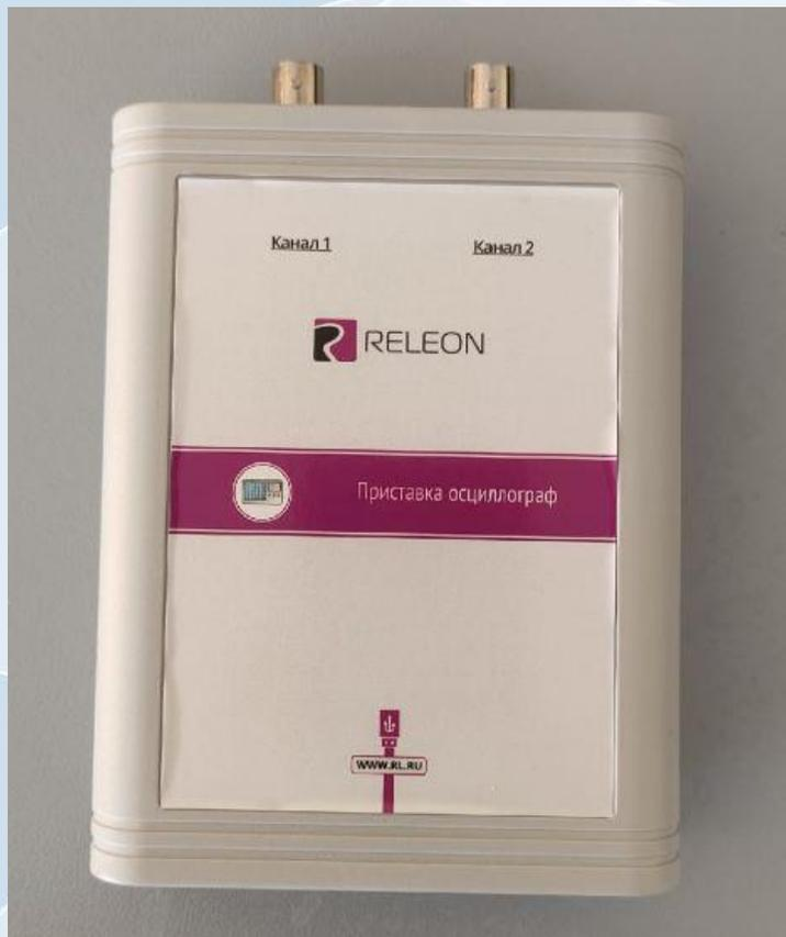
Двухканальная приставка-осциллограф предназначена для исследования формы электрических сигналов по двум каналам путём визуального наблюдения и измерения их амплитуд и временных интервалов.
