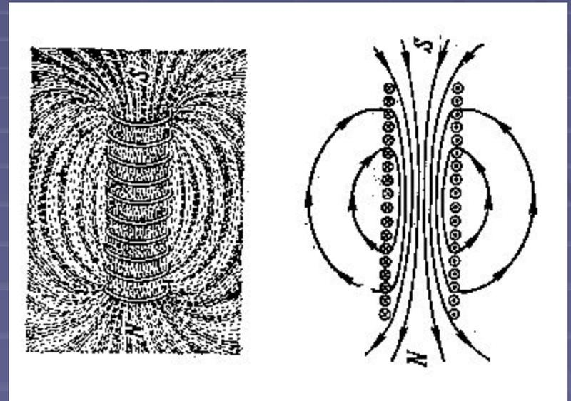
*Линии магнитного поля – магнитные линии*
