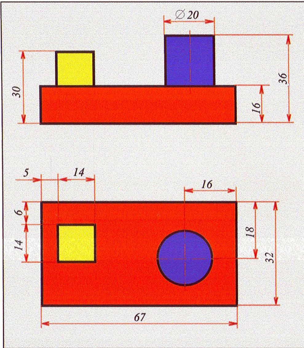
Размеры на чертежах условно подразделяются на габаритные, координатные и контурные.
