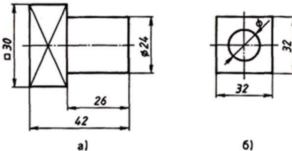
**Рис. 49. Нанесение размеров квадратных по форме элементов**
