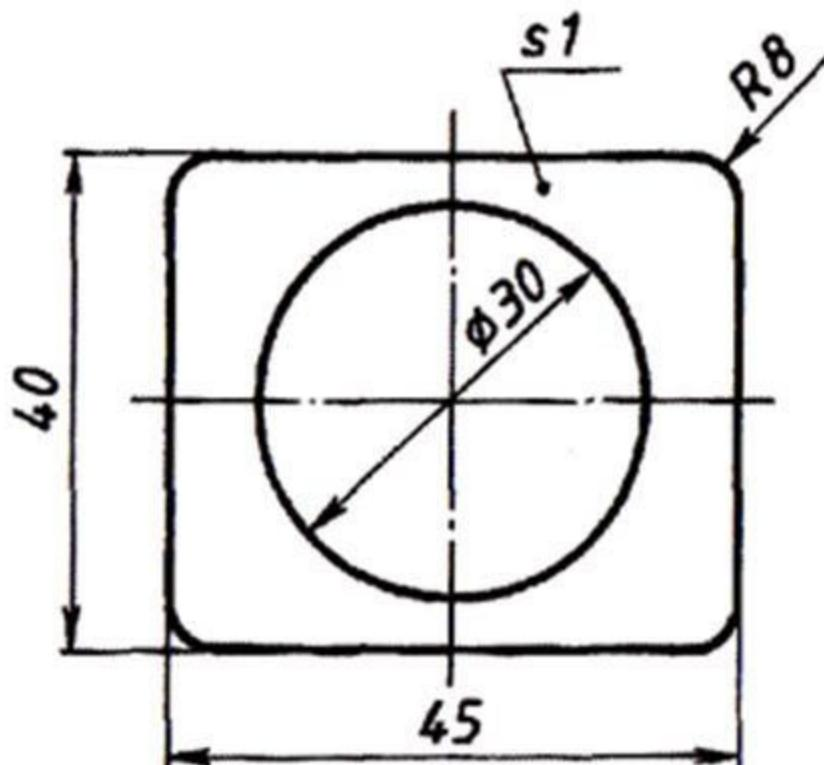
**Рис. 50. Нанесение размера
