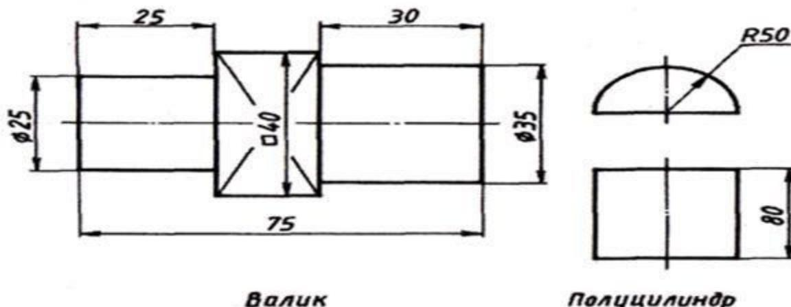
Рис. 53. Пример нанесения габаритных размеров
