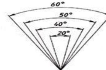
Рис. 43. Нанесение размеров в шахматном порядке
