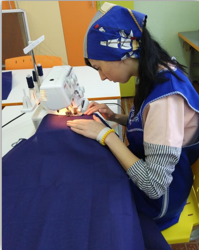
обработка боковых срезов деталей основы платья оверлоком
