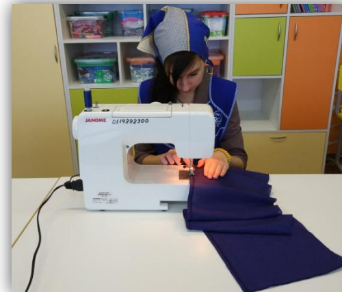
3. обработка нижнего среза волана швом вподгибку с открытым срезом
