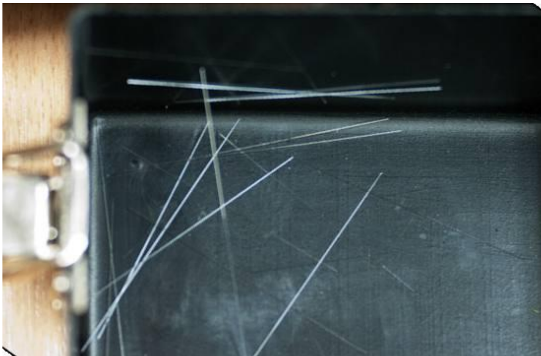
Кусочки оптических волокон – остатки очищенного от цветного защитного лака волокна (125 мкм) после скалывателя
