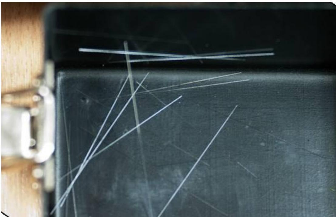
**Кусочки оптических волокон** – остатки очищенного от цветного защитного лака волокна (125 мкм) после скалывателя
