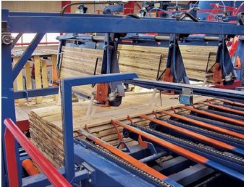
Система укладки в штабель досок, брусьев и других заготовок
