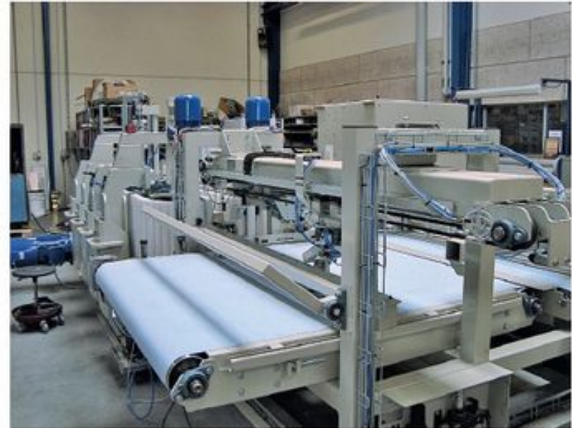
ТВЧ-пресс непрерывного действия для сборки деталей оконных и дверных коробок
