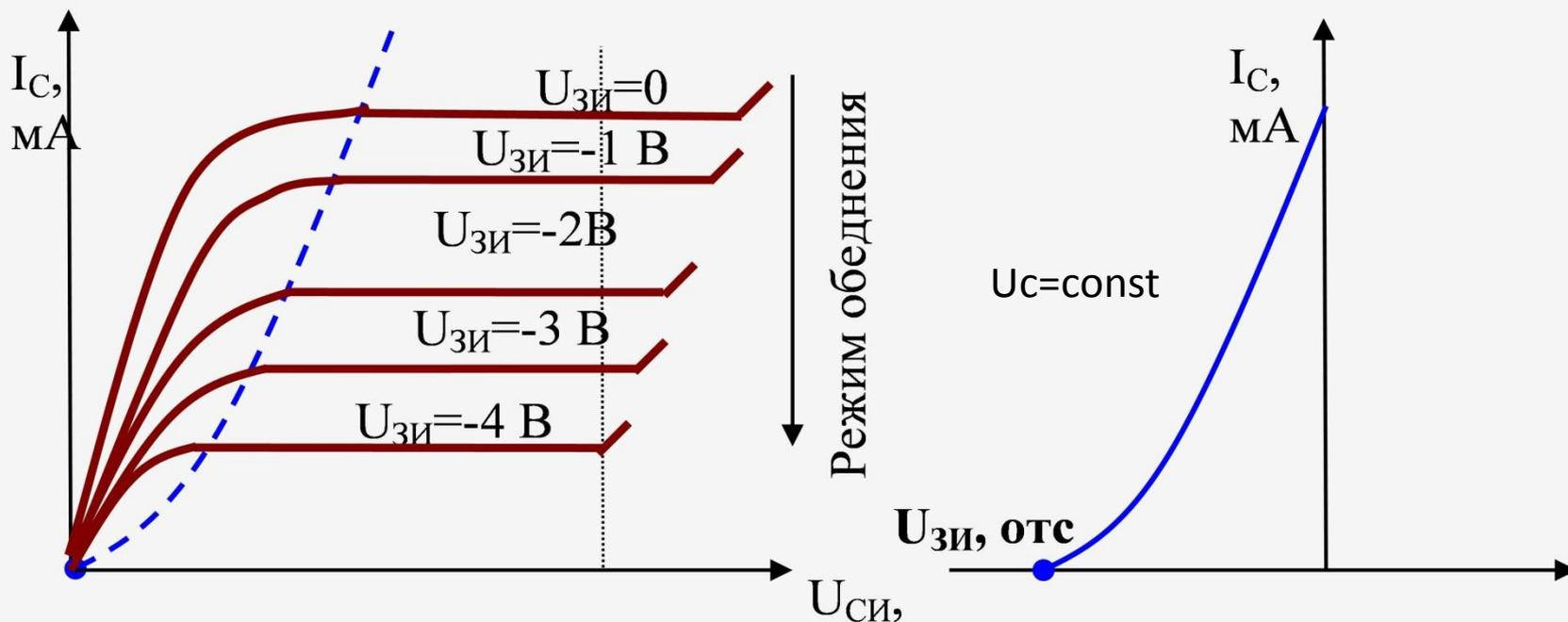
Когда суммарное напряжение достигнет напряжения запираения: ширина канала уменьшится, а его сопротивление возрастет. При определенном значении  $U_{ЗИ}$ , которое называется напряжением отсечки, ток стока практически не протекает.
