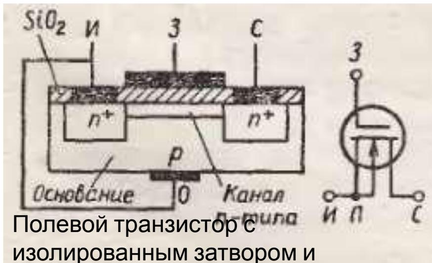
Полевой транзистор с изолированным затвором и встроенным каналом
