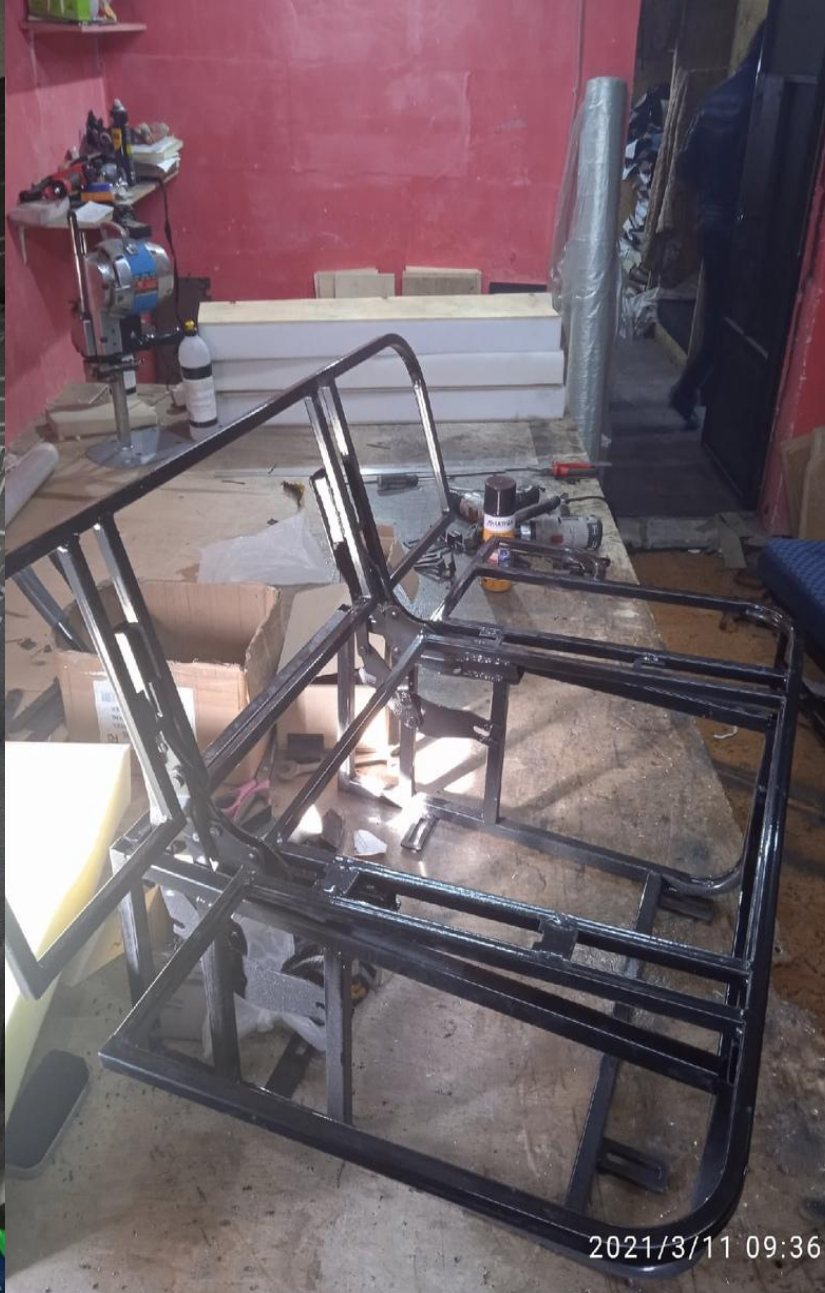
Монтаж спальника-трансформера осуществляется на штатные места, по средством 4 болтов.
