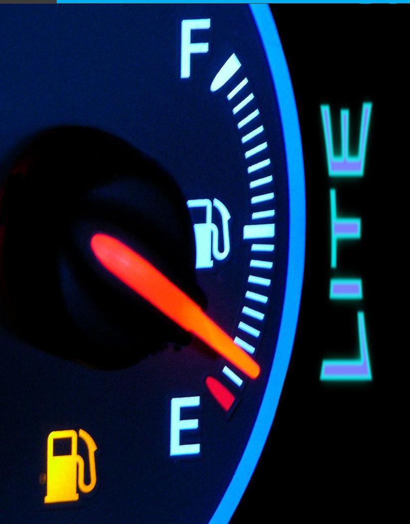
Предназначены для информирования водителя об уровне топлива в баке автомобиля. Поплавок посредством длинной штанги воздействует на секторный реостат, который изменяет сопротивление датчика в зависимости от уровня топлива в баке автомобиля. Сигналы датчика поступают на стрелочный или электронный указатель на панели управления автомобиля.
