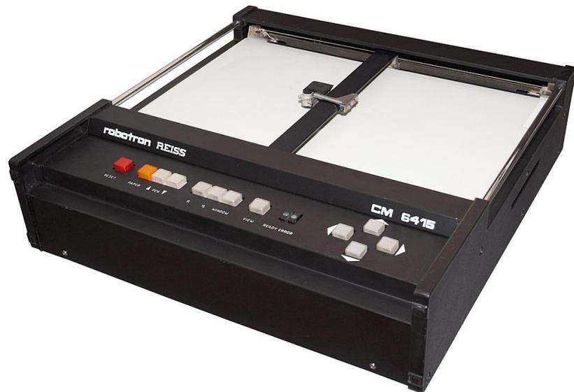
Графопостроитель – устройство для графического вывода информации на бумагу.
