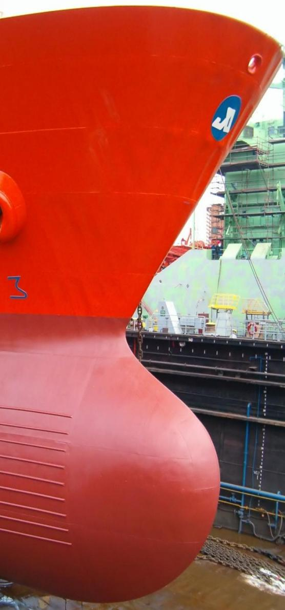
**Волновое сопротивление определяется в опытовом бассейне, на модели проектируемого судна.**
