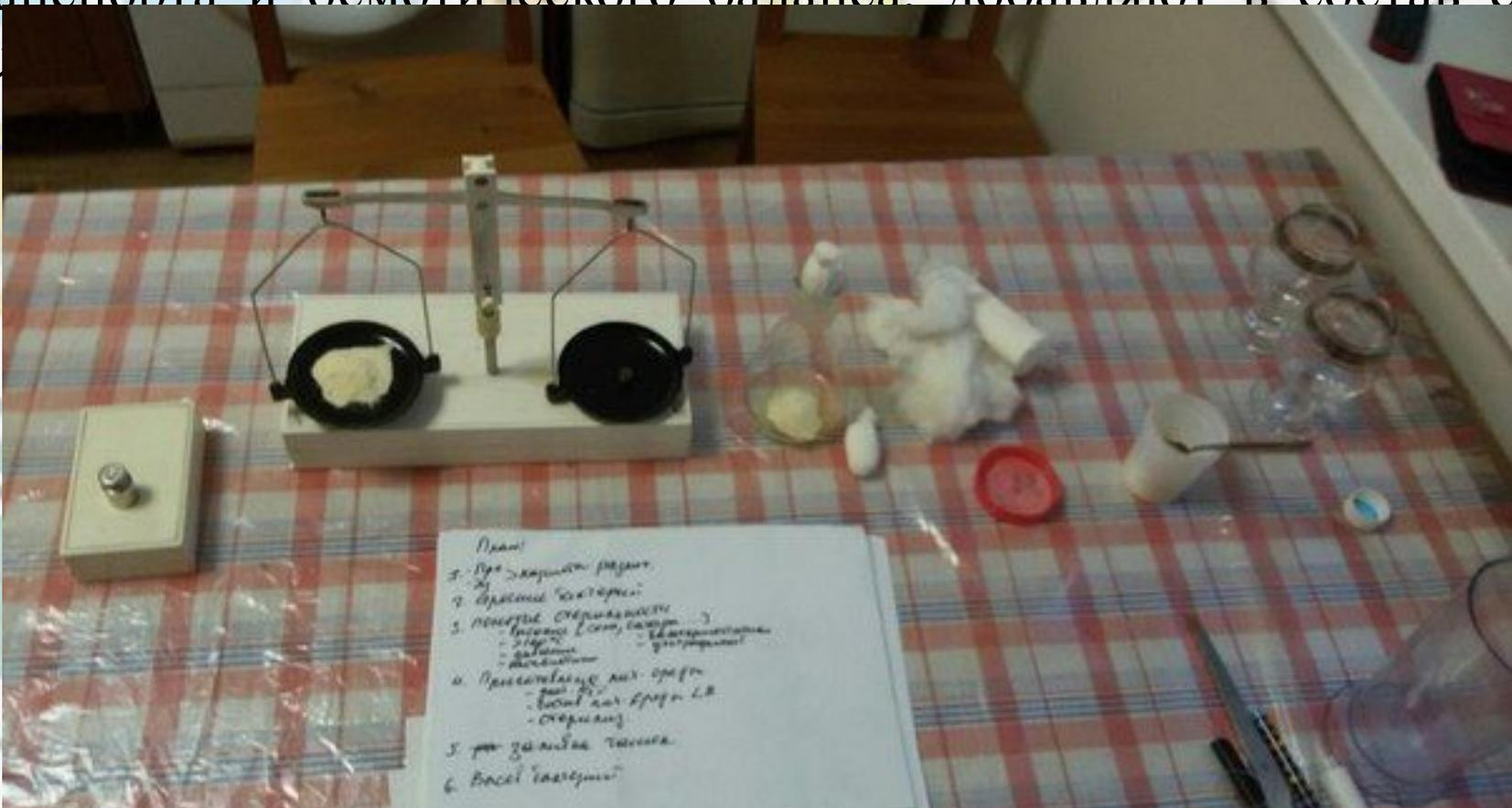
2. Колба со средой ЛВ и чашки Петри были простерилизованы в сухожаровом шкафу в течение часа при 120 С.
