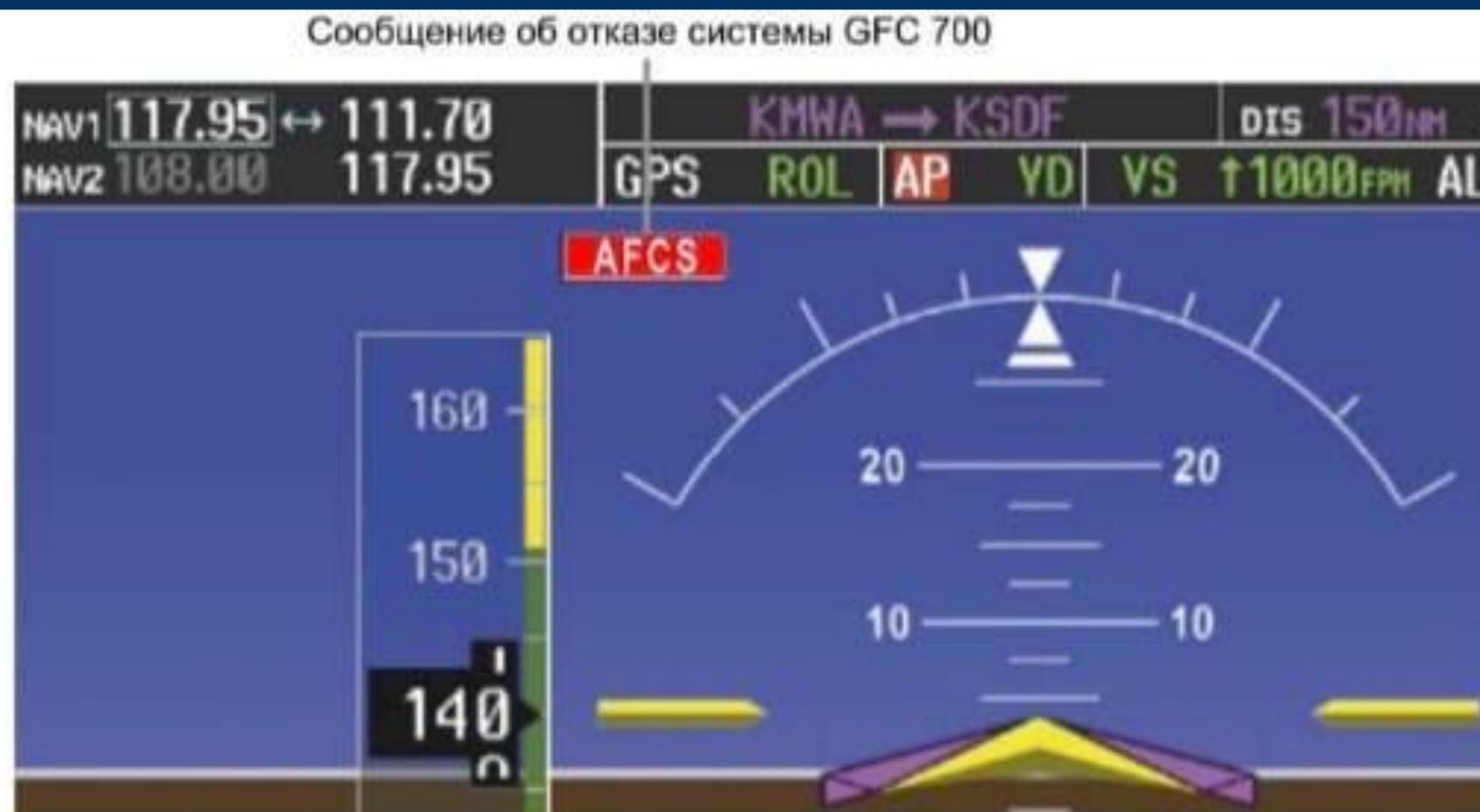
Рис. 3.23. Сигнализация об отказе системы автоматизации управления полётом AFCS
