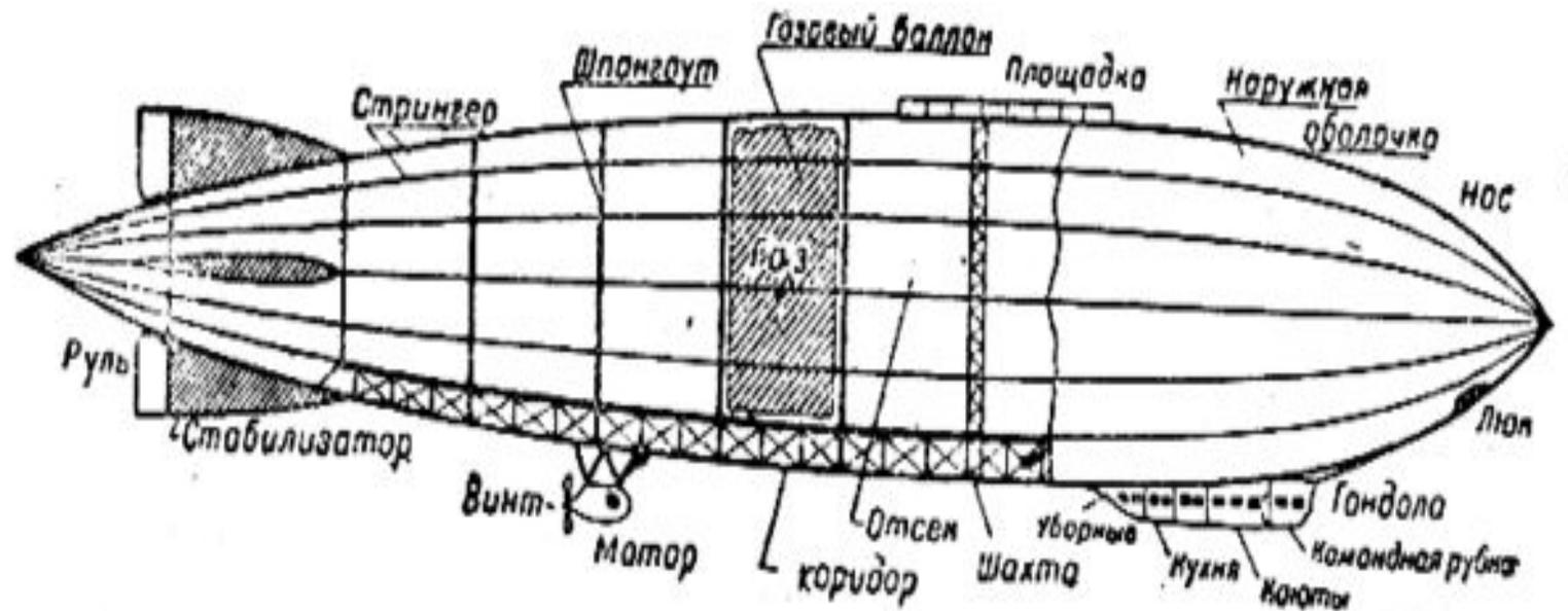
Рис. 11. Схема дирижабля жесткой системы (типа цеппелин).
