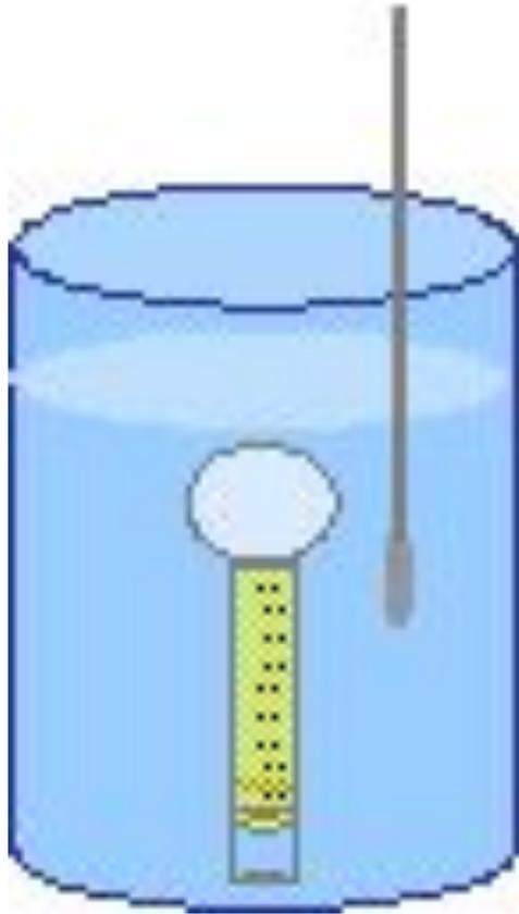
Прибор А. Вольта для измерения расширения газа при изменении его температуры
