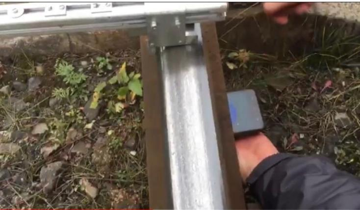
Сейчас мы можем использовать МРМ, как индикатор измерения подуклонки рельс, применяемых на ВСМ, преимущественно на кривых участках пути. Данное предложение уже реализовано и может быть использовано в работе.
