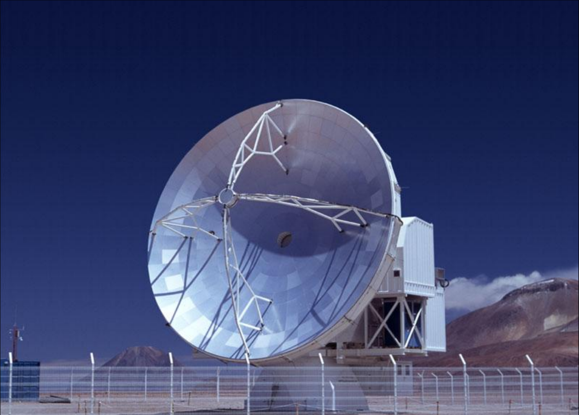
APEX - Atacama Pathfinder Experiment(ESO), D=12 m, 0,2-1,5 mm, пл.Чохнантор
