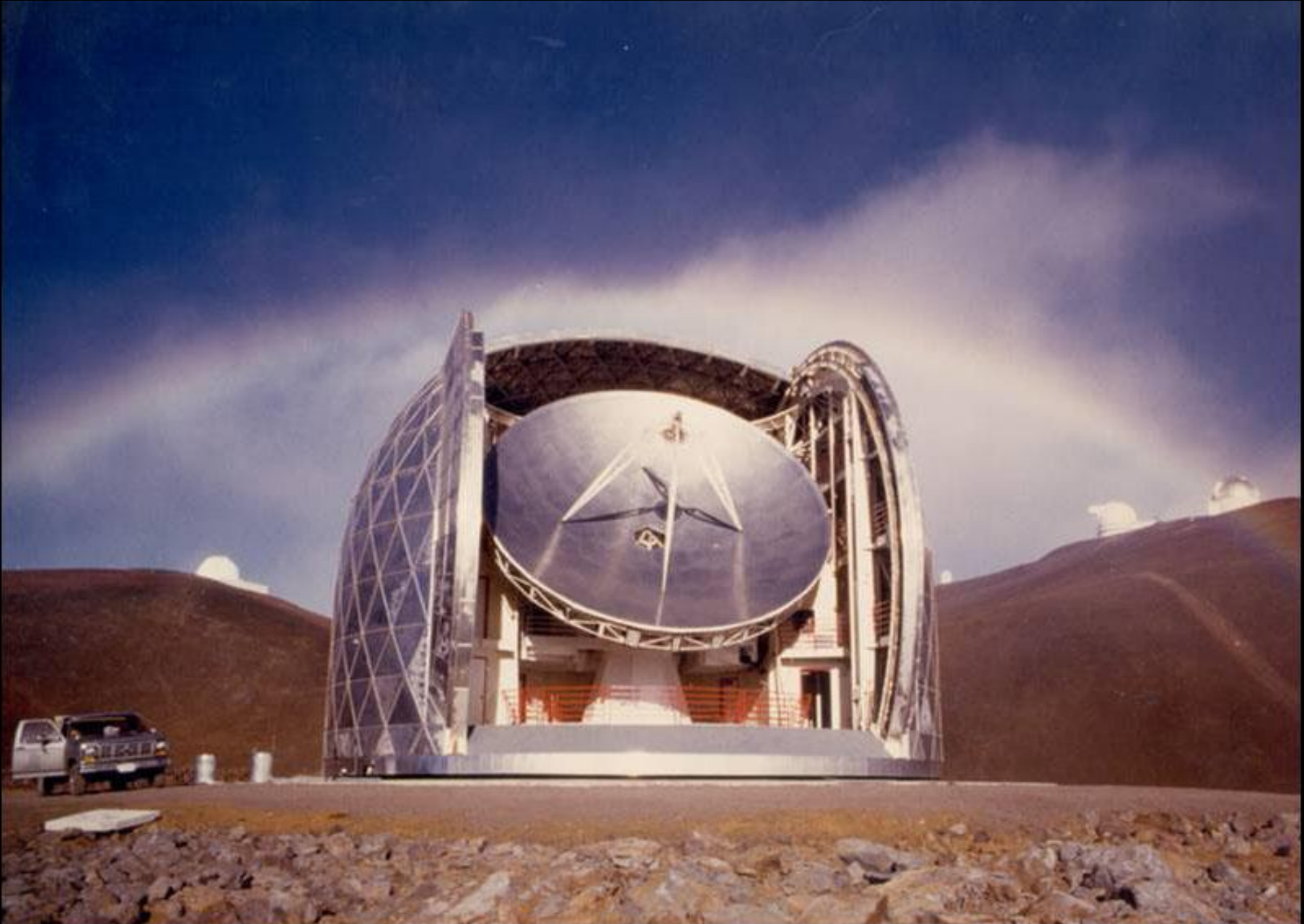
10-м субмм (300 мкм - 3 мм) Калифорнийский телескоп CSO на Мауна-Кеа
