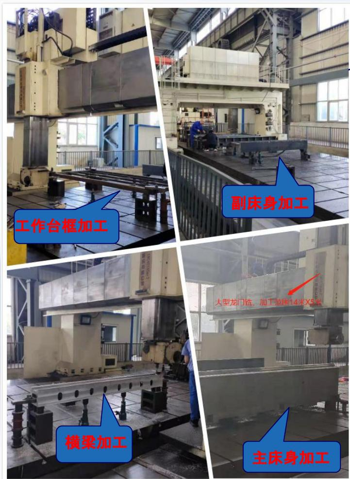
超大型龙门五面体加工中心,最大加工范围18米X5米
