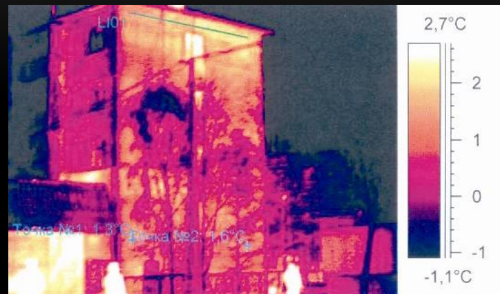
Инфракрасный снимок поверхности стен жилого дома до нанесения Изоллата
