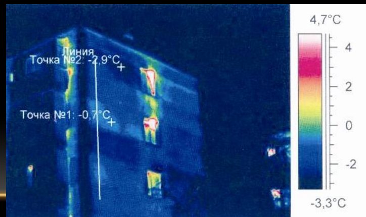
Инфракрасный снимок поверхности стен жилого дома до нанесения Изоллата
