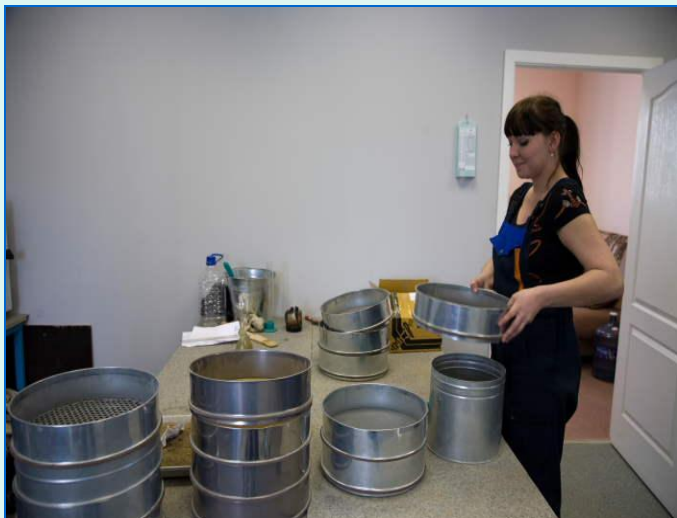
Определение зернового состава заполнителя производится просеиванием сухого заполнителя через набор стандартных сит.
