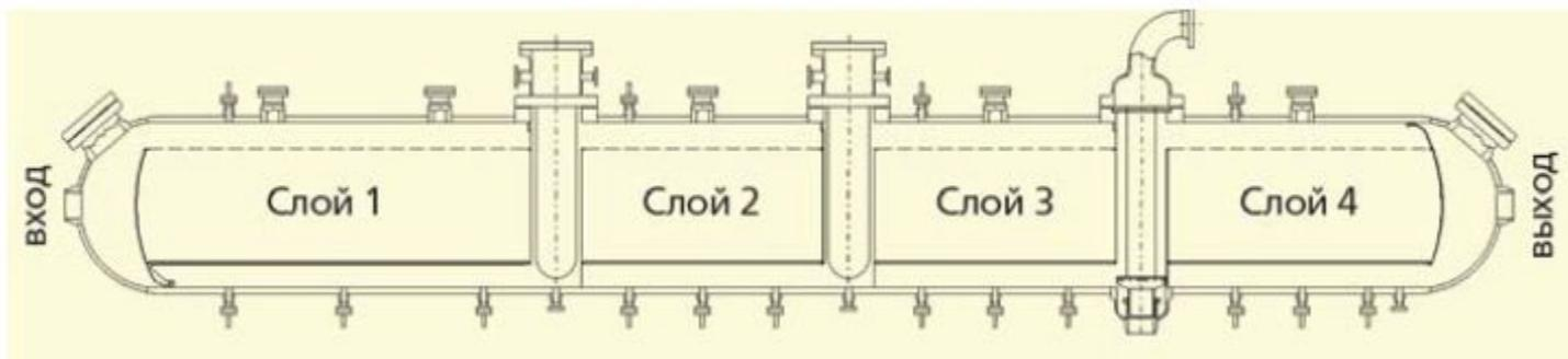
Рисунок – Принципиальная схема конструкции реактора синтеза метанола фирмы «Casale»: 1 – вход свежего синтез-газа; 2 – выход охлаждающего агента; 3 – теплообменная пластина; 4 – корзина для засыпки катализатора; 5 – вход охлаждающего агента; 6 – выход газо-продуктовой смеси.
