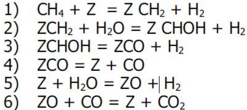
Здесь Z - свободное место на поверхности никеля, принимаемое двухвалентным, а ZCH<sub>2</sub>, ZCHON, ZCO и ZO - хемосорбированные радикалы - CH<sub>2</sub>, CHON, молекула оксида углерода и атомарный кислород соответственно.
