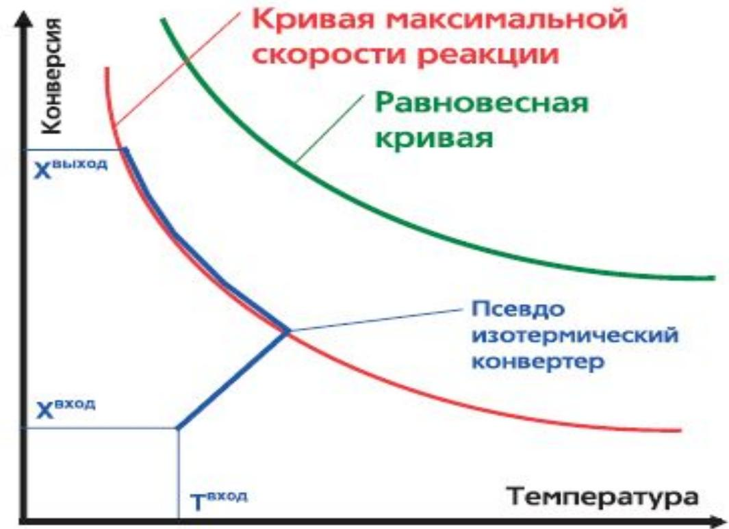
Применение охлаждающих пластин позволяет удалять различное количество тепла в разных частях реактора, достигая максимального использования объёма катализатора с распределением температур, соответствующим самой высокой скорости реакции
