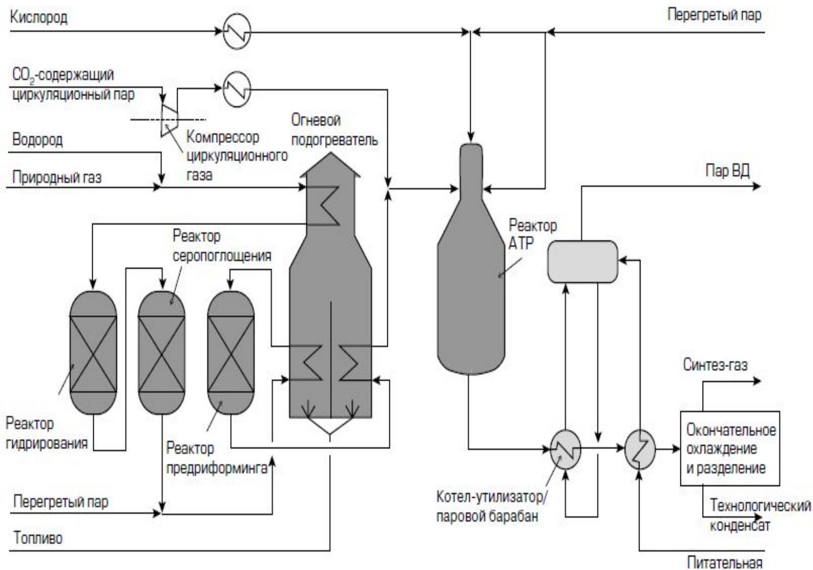
Тепло подводится за счёт частичного сгорания метана. Реактор адиабатического типа. В реакторе АТР газ нагревается от 650 до 1000°C. Кат: Ni (3-12 масс. %) на  $\alpha\text{-Al}_2\text{O}_3$ . P = 3-4 МПа
