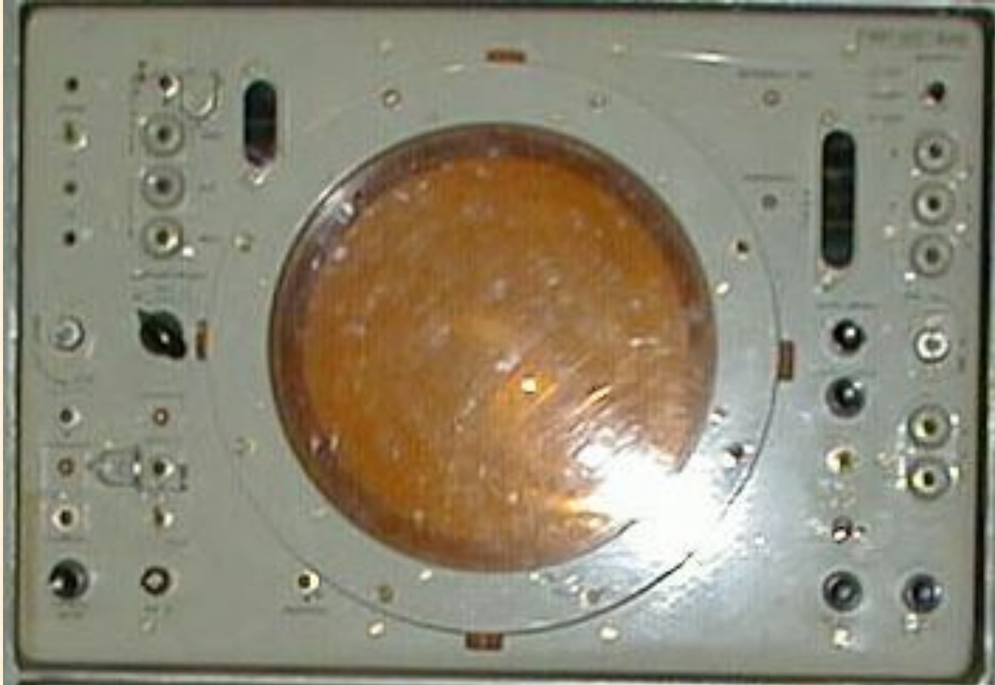
Система индикации расположена ( блок ОП81-16М2 ) в стойке левой СЛ-2М операторского отделения
