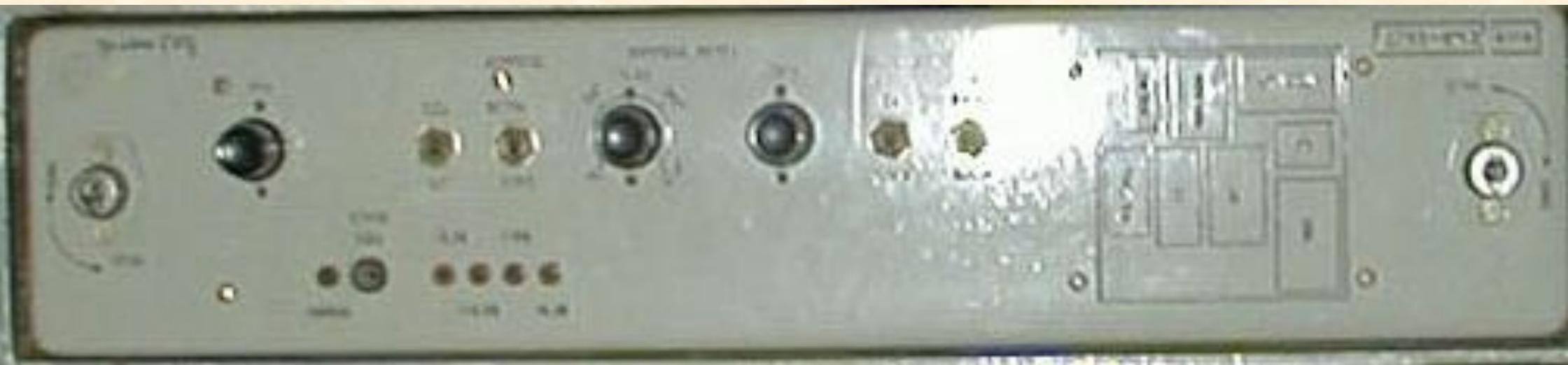
При установке переключателей «ШТ - СДЦ» в положение «СДЦ», «Компенсация ветра - ОТКЛ» в положение «Компенсация ветра» вращением ручек «Компенсация ветра грубо, точно» блока ОП63-6МЗ удаётся скомпенсировать пассивные помехи, а в положении тумблера СДЦ «внешняя» одновременно от местных предметов и движущихся помех.
