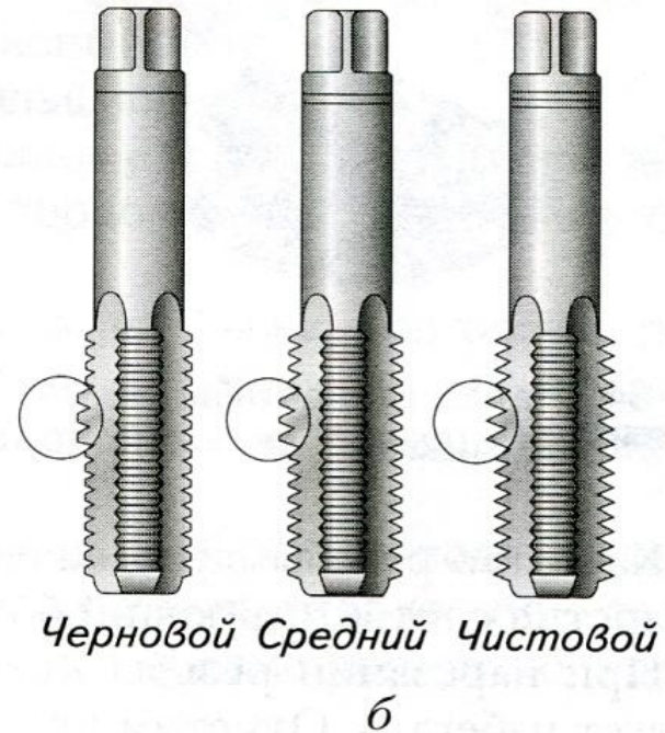
Рис. 63. Метчики: а — основные элементы; б — комплект для нарезания метрической резьбы
