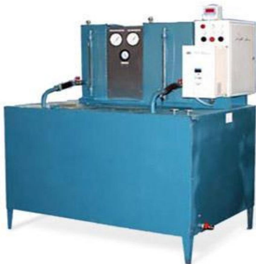
Собранный насос следует испытать на специальном стенде 10-15 мин. При частоте вращения шкива 3500 об/мин-1 шкив должен обеспечить напор не менее 130 кПа (1,3 кгс/см<sup>2</sup>), подачу не менее 0,009 м<sup>3</sup>/с при потребляемой мощности не более 4 кВт. После установки на двигатель крыльчатка насоса не должна задевать корпус водяных каналов, зазор должен составлять 0,4-1,0 мм.
