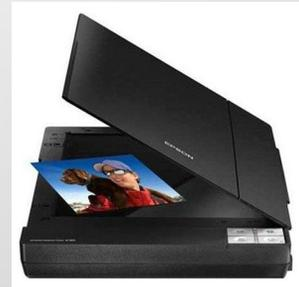
**ПРИНЦИП ДЕЙСТВИЯ** – ЛУЧ СВЕТА, ОТРАЖЕННЫЙ ОТ ПОВЕРХНОСТИ МАТЕРИАЛА ФИКСИРУЕТСЯ СПЕЦИАЛЬНЫМИ ЭЛЕМЕНТАМИ (ПЗС) – ПРИБОРЫ С ЗАРЯДОВОЙ СВЯЗЬЮ. ЕГО УСТРОЙСТВО ПРЕДУСМАТРИВАЕТ ПЕРЕМЕЩЕНИЕ СКАНИРУЮЩЕЙ ГОЛОВКИ (ЛИНЕЙКА СВЕТОДИОДОВ) ОТНОСИТЕЛЬНО ОРИГИНАЛА С ПОМОЩЬЮ ШАГОВОГО ДВИГАТЕЛЯ.
