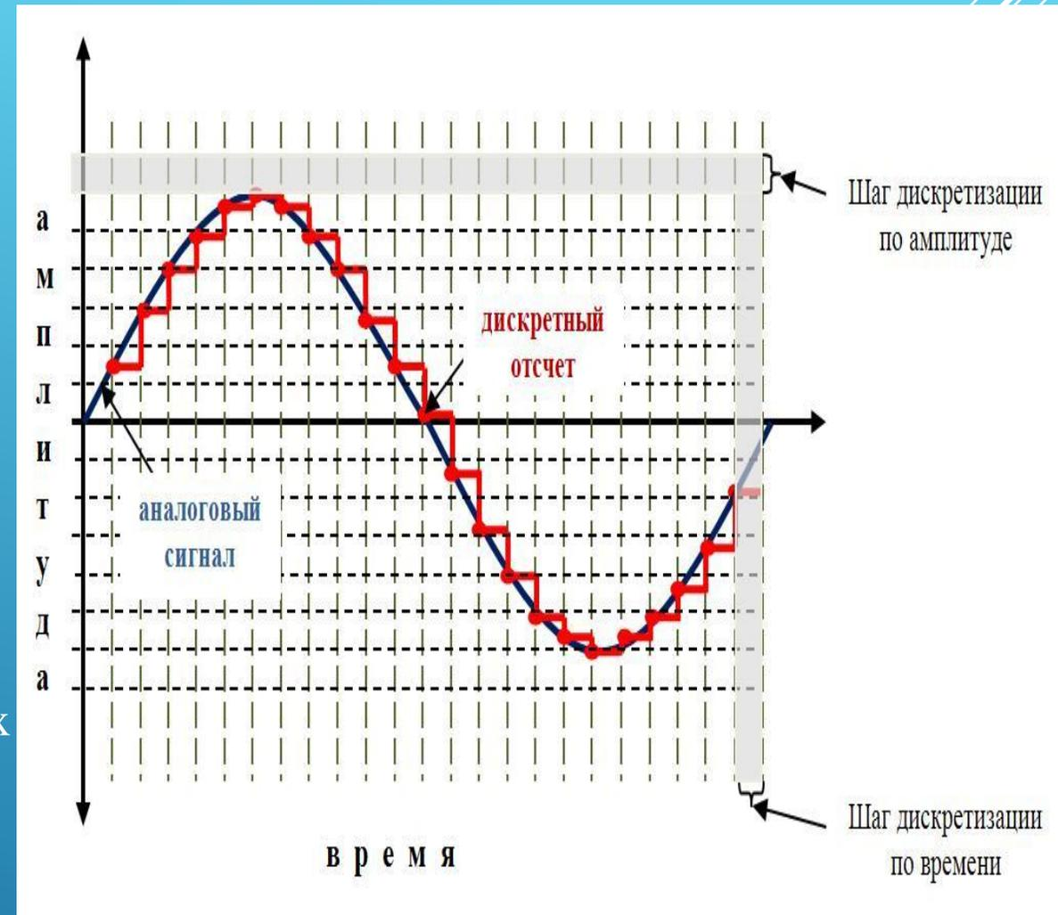
**Теорема Котельникова:** любой непрерывный сигнал, ограниченный по спектру верхней частотой  $F_B$  полностью определяется последовательностью своих дискретных отсчетов, взятых через промежуток времени
