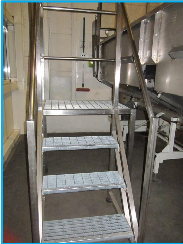
Оснащение бункера преформ площадкой для обслуживания
