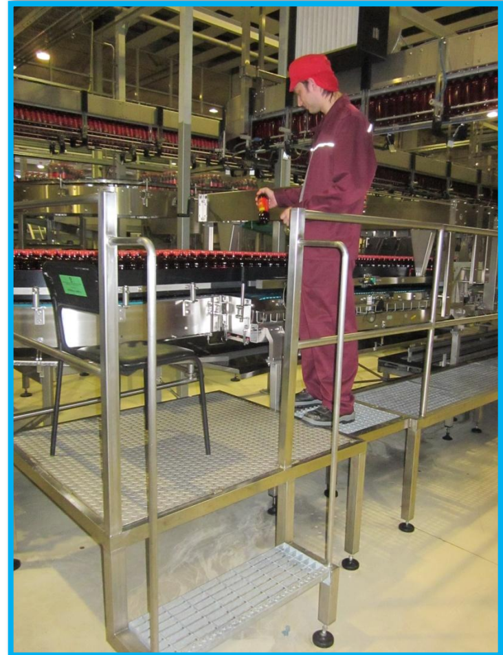
Оснащение вариопака ПЭТ-линии площадкой для обслуживания
