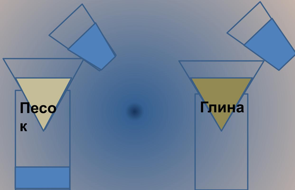
**Вывод: есть горные породы, которые пропускают воду (песок) – водопроницаемые, а есть, которые не пропускают воду (глина) – водонепроницаемые или водоупорные.**
