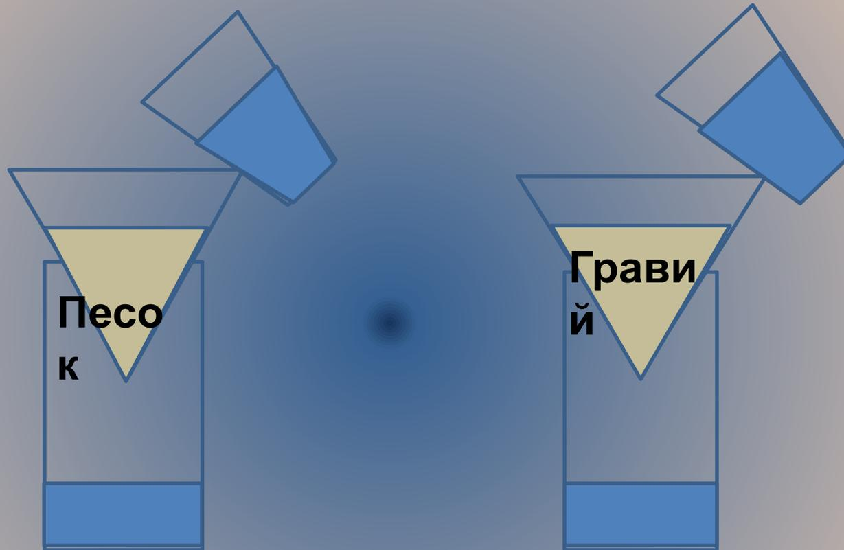
**Вывод: через гравий вода просачивается быстрее. т.к. больше пустот между частицами гравия и гравий крупнее песка.**
