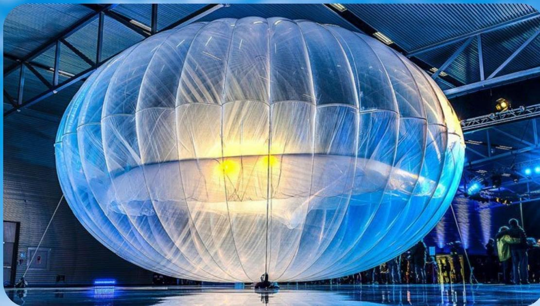
**Идея заключается в том, что воздушные шары (стратостаты) будут постоянно находиться в стратосфере на высоте примерно 18 км и, используя различные воздушные течения, дрейфовать в указанных географических координатах. По задумкам технологов будут использоваться полосы Airwave с широким спектром покрытия в 700 МГц и 2500 МГц**
