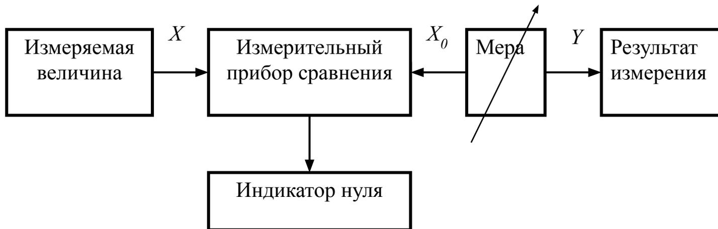
Схема нулевого метода измерения
