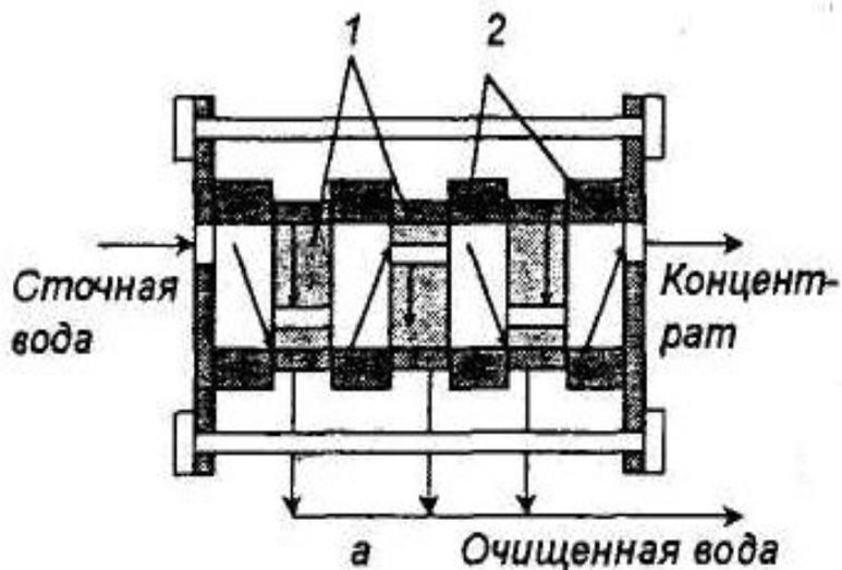
Трубчатый фильтрующий элемент: 1 – трубка;
