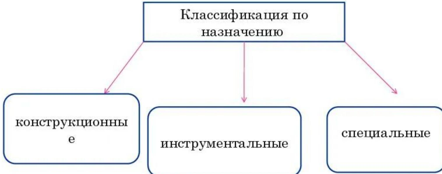
**Конструкционная сталь** — это сталь, которая применяется для изготовления различных деталей, механизмов и конструкций в машиностроении и строительстве и обладает определёнными механическими, физическими и химическими свойствами.
