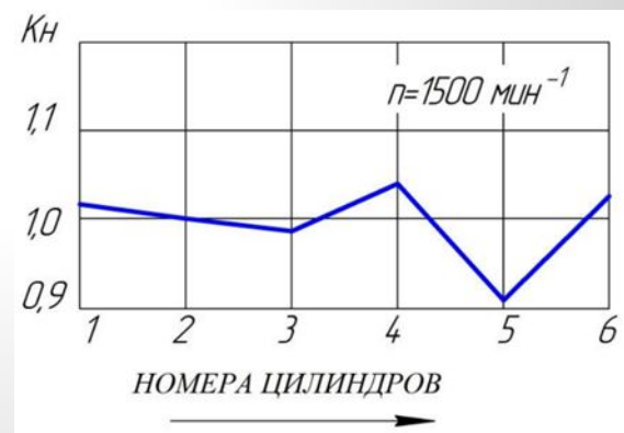
Рисунок 1.9 – Распределение расхода воздуха по цилиндрам на стенде динамической продувки
